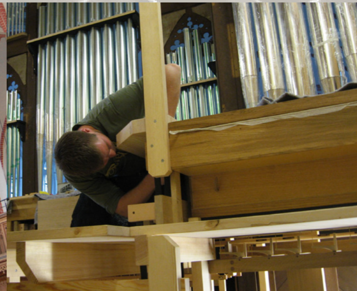
Orgelbauer Malte Kempf arbeitet an der Registermechanik Foto: Klosterkammer Hannover
