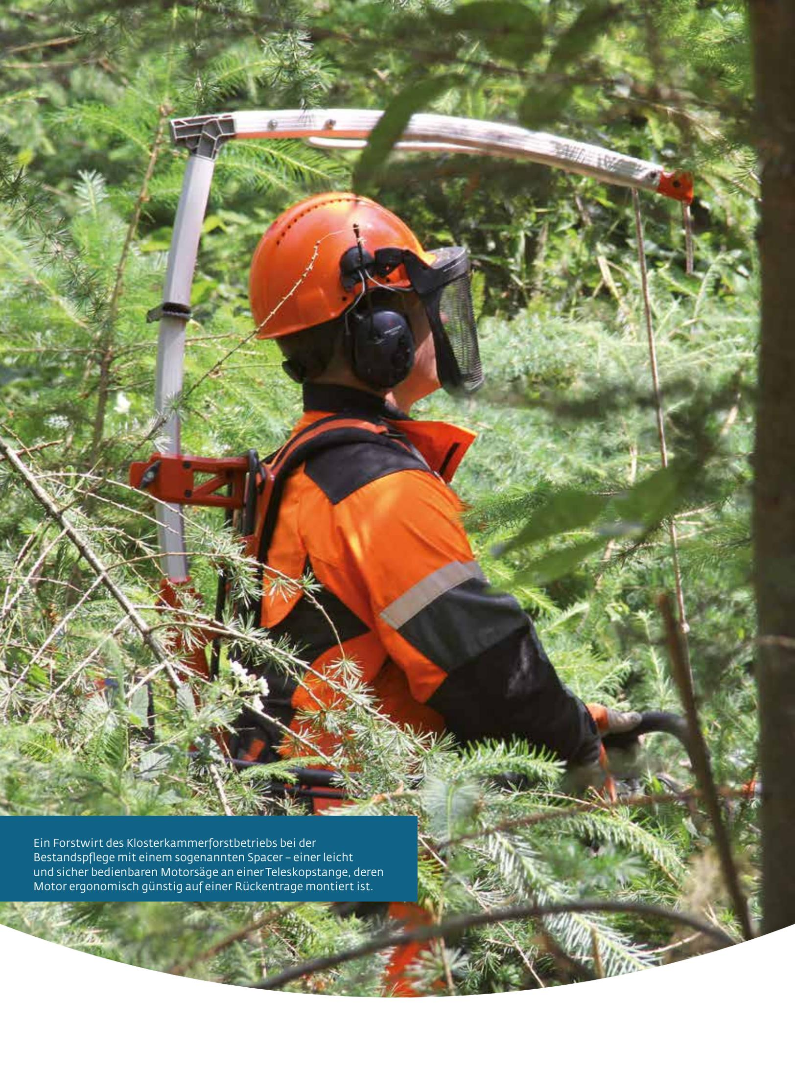
Ein Forstwirt des Klosterkammerforstbetriebs bei der Bestandspflege mit einem sogenannten Spacer – einer leicht und sicher bedienbaren Motorsäge an einer Teleskopstange, deren Motor ergonomisch günstig auf einer Rückentrage montiert ist.
